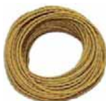
3690 Treccia cotone - Sezione 3x0,75mm 2 - Tpo FRRTX con filo di terra evidenziato - Conduttori isolati in PVC a doppio isolamento - Matassa da 100m Cotton braid - Section 3x0,75mm 2 - FRRTX type with evidenced earth thread - Insulated conductors made in double insulation PVC - 100m roll
