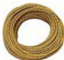
3692 Tresse coton - Section 3x1,5mm 2 - Type FRR-TX avec fil de terre en évidence - avec fil de terre en évidence - Conducteurs isolés en PVC double isolation - Bobine de 50m
